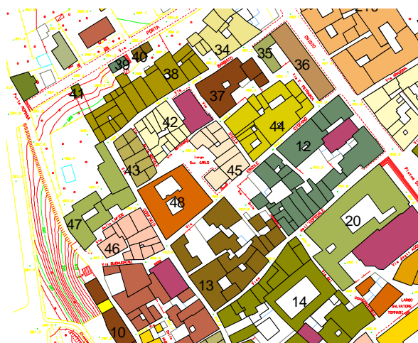
A sinistra: Mappa delle unità strutturali (in giallo), degli edifici strategici, delle scuole e di culto. A destra particolare con la numerazione degli aggregati; le linee sottili individuano gli edifici (unità strutturali).
