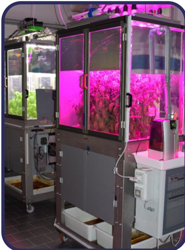
L'obiettivo principale era di sviluppare una nuova generazione di lampade da impiegare in ambienti chiusi, consentendo di ottenere elevati standard di crescita e sviluppo di piante in ambienti non convenzionali, sia ai fini di ricerca applicata che di sviluppo di vere e proprie filiere produttive. Il progetto ISAAC, nasce dalla tecnologia del brevetto ENEA-FOS denominato "Microcosmo per l'allevamento di piante sotto condizionamento biotico e abiotico".
